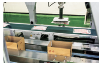
異物混入やパッケージ不良などを検出する「検査工程」から「箱詰め」までのラインを自動化
