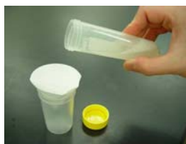
抽出サンプルのろ過 ※小麦のみ、ろ液を5倍希釈します。
