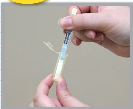
ろ液を凍結乾燥試薬と混ぜ、テストストリップを浸す
