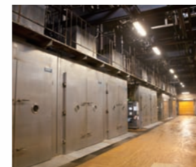
カートに載せられたハムの原木は、カートごと大型のスモークハウスで熱処理（燻製）されます
