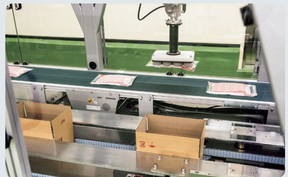
異物混入やパッケージ不良などを検出する「検査工程」から「箱詰め」までのラインを自動化
