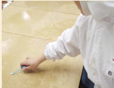
洗浄後の製造設備での残留検査
